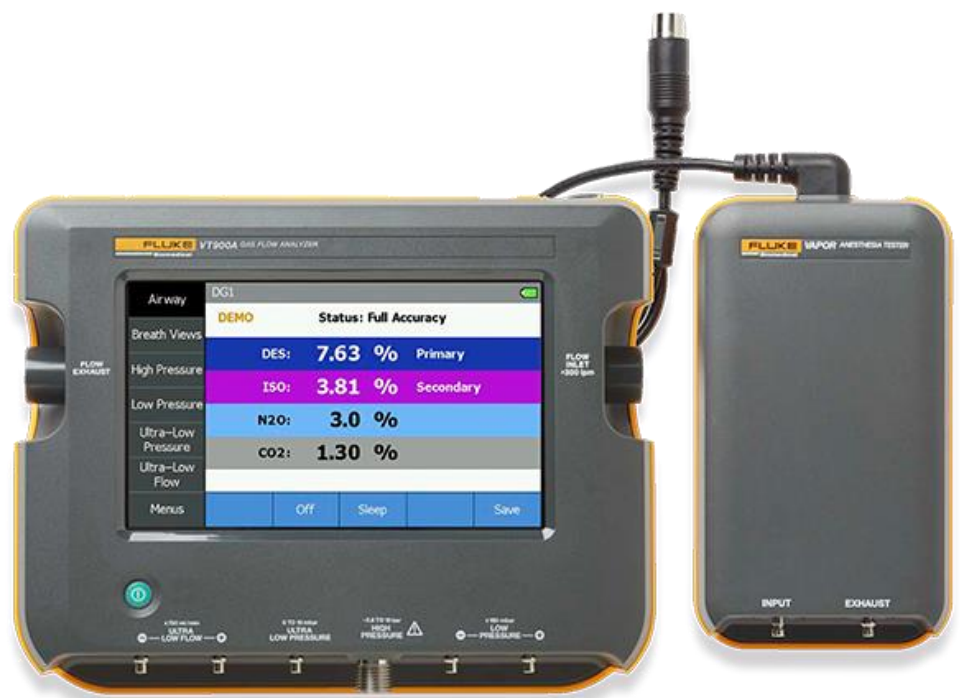
Thiết bị VT900A + VAPOR kiểm tra và hiển thị nồng độ hỗn hợp các loại khí gây mê
